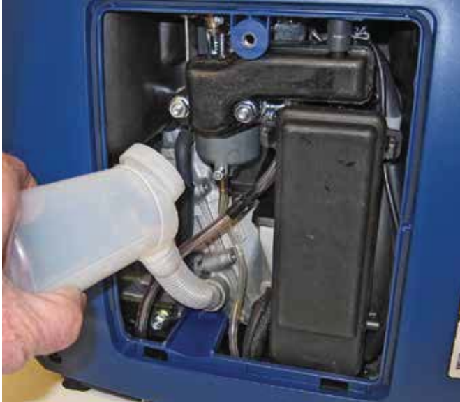
Figura 18 – Procedimiento para agregar el aceite del motor
