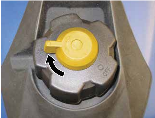
Figura 21 – Ventilación del depósito de combustible
