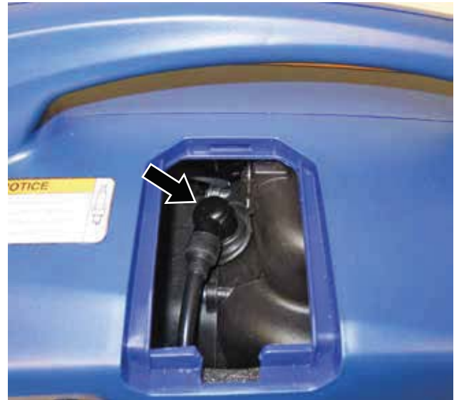
Figura 35 – Procedimiento para retirar el capuchón de la bujía de encendido (se muestra el modelo WH1000i)
