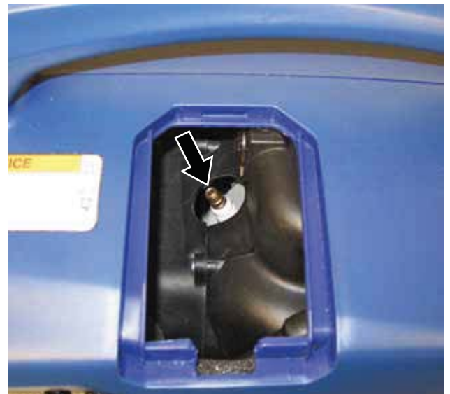
Figura 36 – Procedimiento para extraer la bujía
