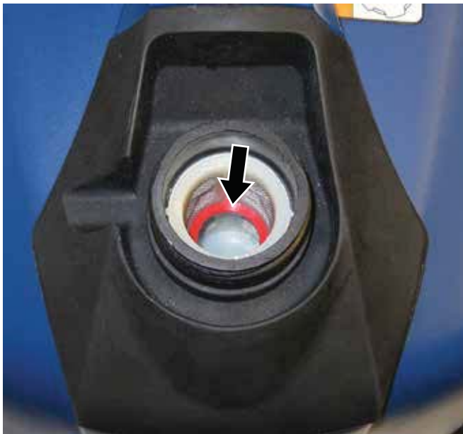
Figura 20 – Nivel máximo de carga de gasolina
