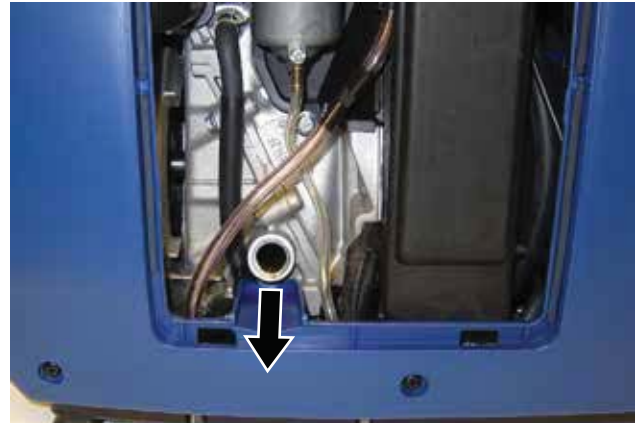
Figura 30 – Drene el aceite del motor (se muestra el modelo WH1000i)
