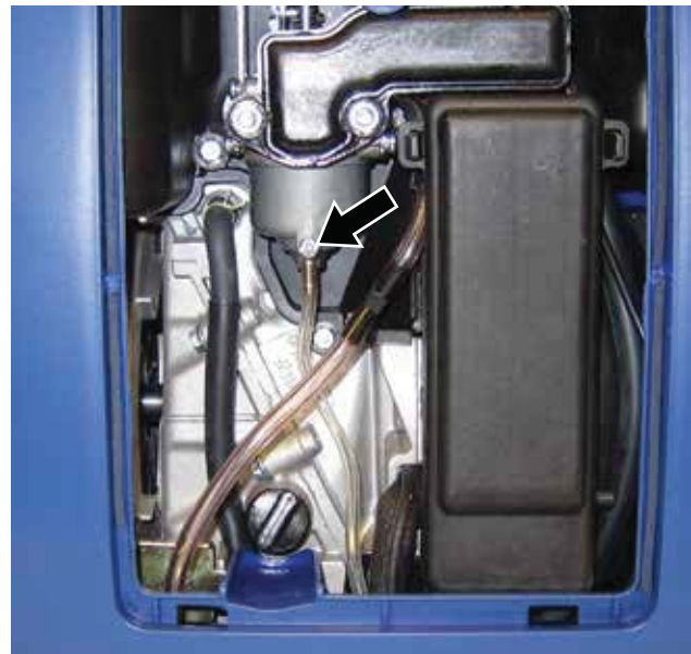
Figura 33 – Tornillo de drenaje de la cubeta de flotación
