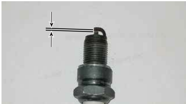
Figura 37 – Requisitos de separación de la bujía
